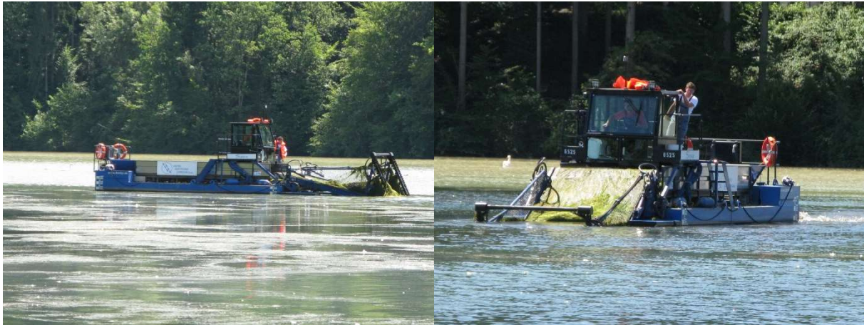
Slika 14: Plovilo s podvodno kosilnico, ki se uporablja za podvodno košnjo problematične vodne zarasti (pretežno vrste E. canadensis ) na Zbiljskem jezeru (vir: Delo)
