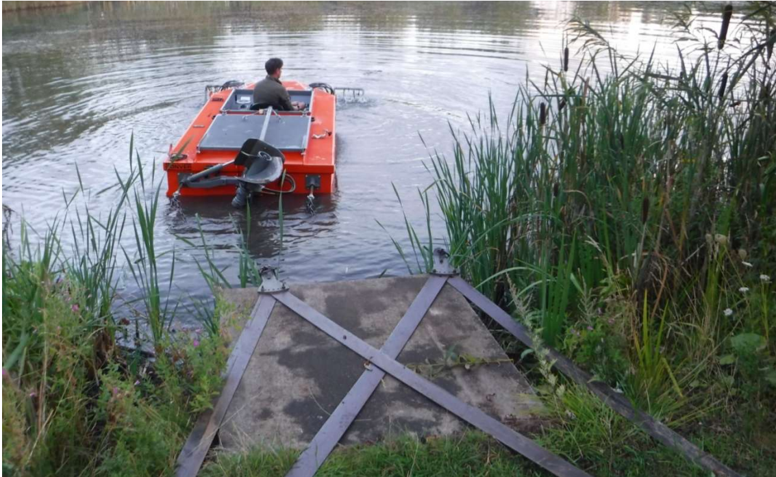
Slika 15: Pridrno V-rezilo, ki se uporablja za obvladovanje problematične vodne zarasti (vir: https://www.aquacontractor.co.uk/ )
